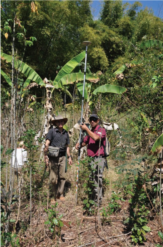
Figure 2: Utilisation du GPS Leica 1200.
